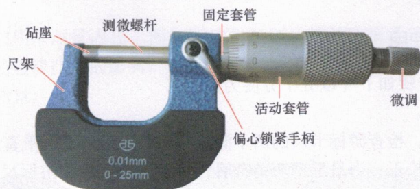
图 4-10 外径千分尺的结构
